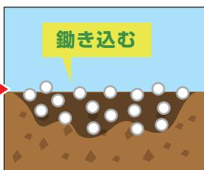
セラミック珪藻土を鋤き込む事で油を吸着します。
